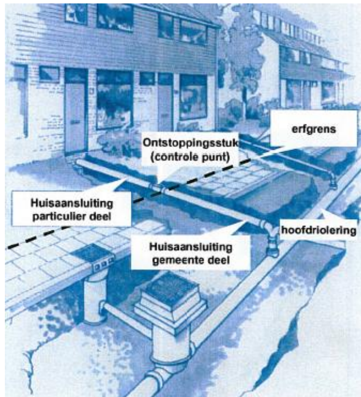
figuur 8: Principesituatie aansluiting woning op gemeentelijk riool
