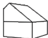
S2 - Woning 2-laags mank dak
