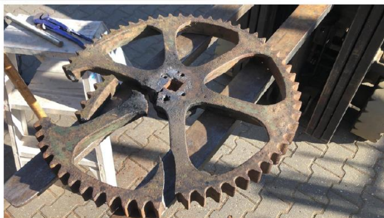
Het gietijzeren kruirad dat in 1951 ook al aanwezig was bleek in de grond te zijn gezakt en gebroken. Het was zeer bros gietijzer dat niet kan worden hersteld.
