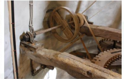
Aandrijfas voor de elevator en mengketel. Deze as kan op de wind en met een oorspronkelijke elektromotor worden aangedreven.
