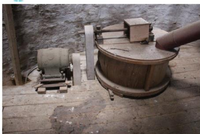
Mengkel met elektromotor aandrijving
