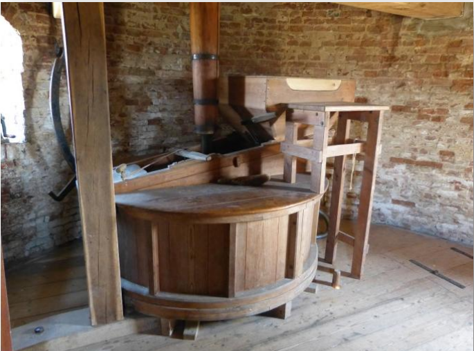
(Het koppel 16er kunststenen, zoals het al sinds 1987 opgesteld staat in de molen. Links is de zogenaamde steenkraan te zien, waarmee de bovenste molensteen gelicht kan worden.)
