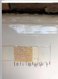
locatie 1: Voordeskoxijn met raam Vog oude lijnolie verflagen aanwezig, 7 verflagen visueel duidelijk zichtbaar. 1 e lagen duidelijk oker kleurstelling aanwezig.
