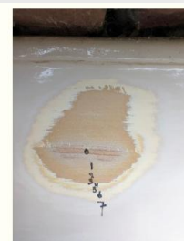
locatie 1: Voordeskoxijn met raam Vog oude lijnolie verflagen aanwezig, 7 verflagen visueel duidelijk zichtbaar. 1 e lagen duidelijk oker kleurstelling aanwezig.
