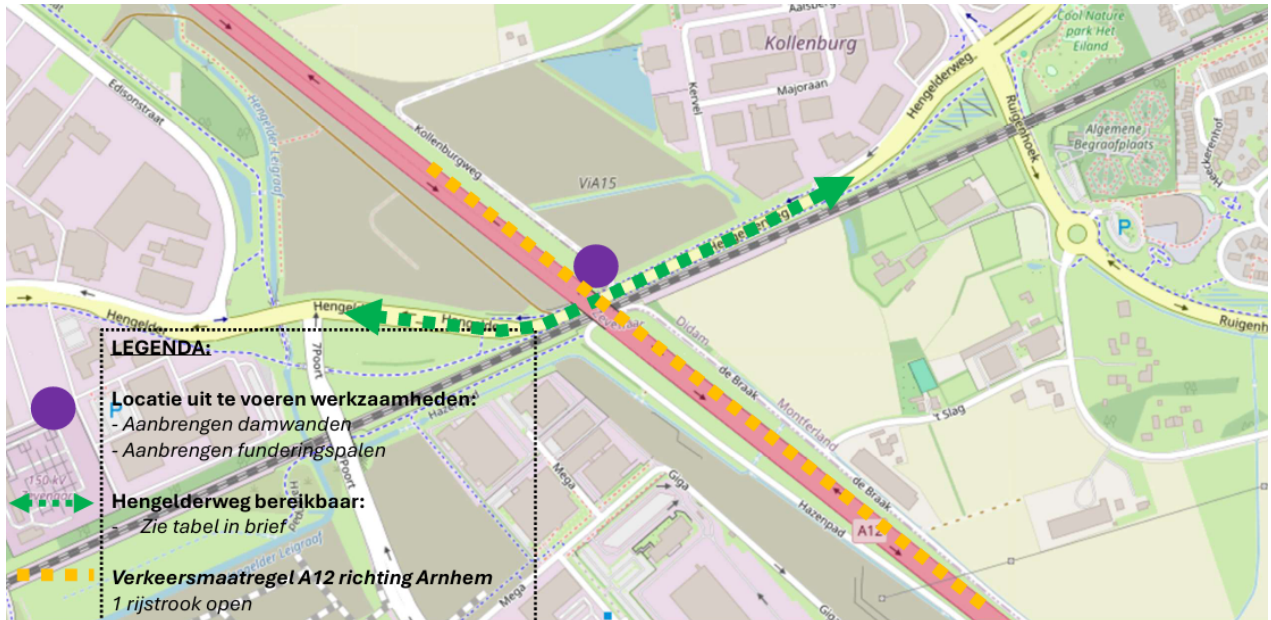
Figuur 1: overzichtskaart werkzaamheden viaduct A12/Hengelderweg in week 27 en 28
